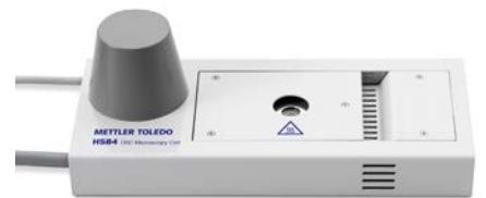
HS84 DSC热台，不仅可控制温度和观察样品，还可同时记录样品外观和热效应。 温度范围：RT~375°C
