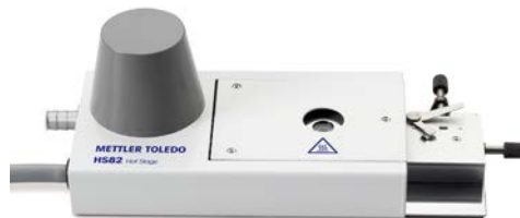
HS82显微热台，进行样品加热和冷却，并同时在显微镜下观察。 温度范围：RT~375°C 选配冷却系统 -90°C~375°C
